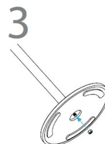
3. 45° Adapter mit der beiliegenden, großen Inbusschraube oben an der Stange befestigen.
